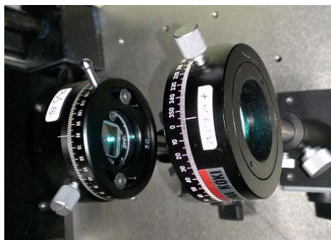
図 12 左から \lambda/2 板と偏光板
