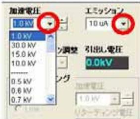
加速電圧表示部分をクリックします。
