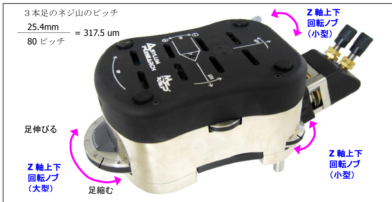
図 40 Z 軸(ヘッド)上下機構
