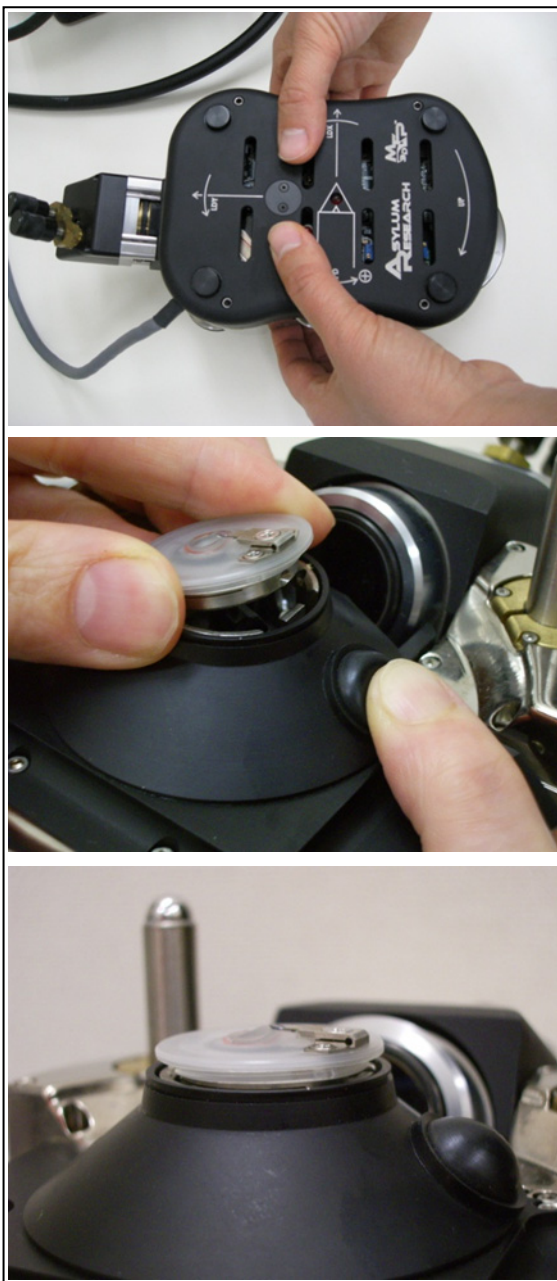
図 39 カンチレバーホルダをヘッドに取り付ける
