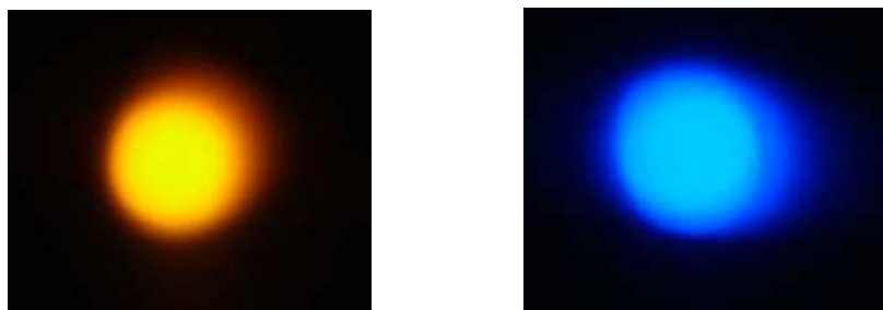
図2. 3 観測されたビームの形状(左がローダミン 590、右がクマリン 480)
