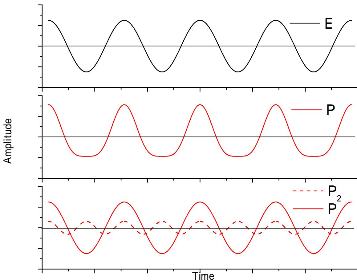
$P_{2\omega}$  の分極が  $E_{2\omega}$  の電磁波を発生
