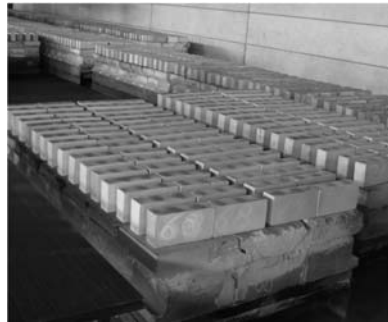
押し出し成形後、ピアノ線による切断
