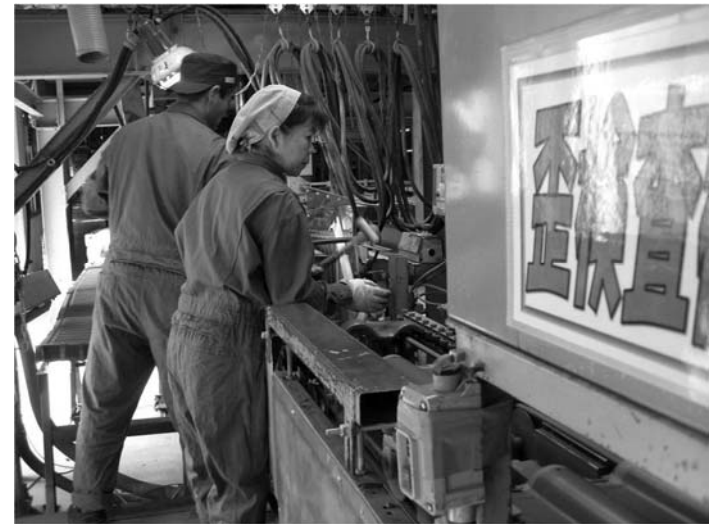
打音検査（マイクロクラックの検査）
