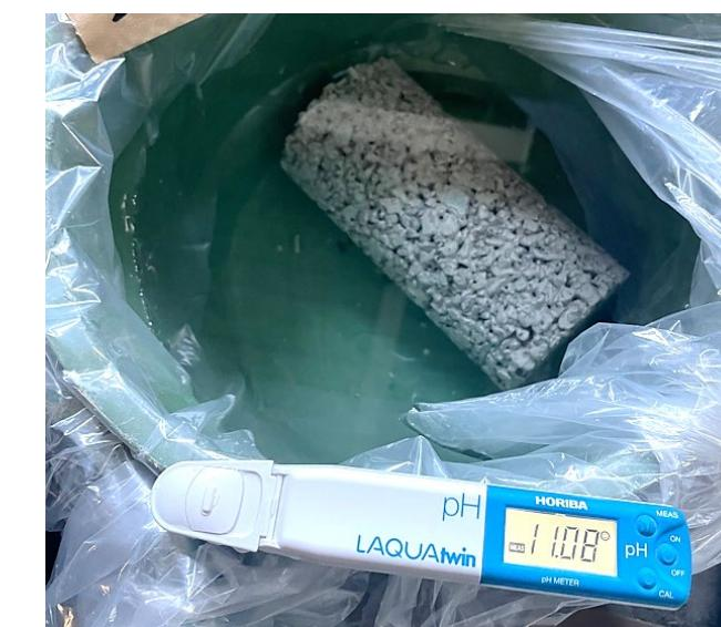
市販のpHメーターを用いて浸漬水の水素イオン濃度(pH値)を測定
