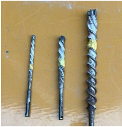
使用したドリルビット φ10mm・φ18mm・φ26mm
