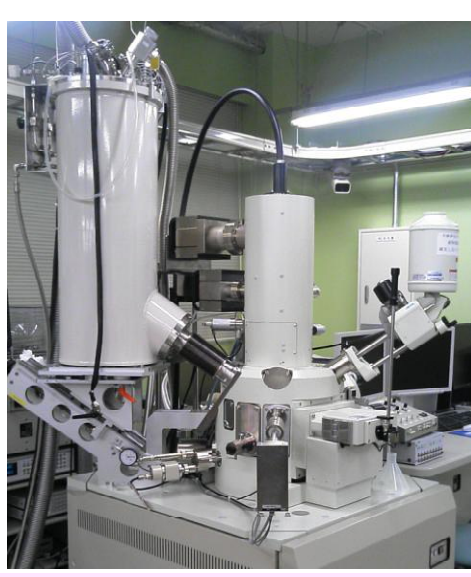
電子顕微鏡用次世代高エネルギー分解能X線検出器TESの開発と応用
