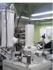
開発したSEM-TES-EDS装置とTES概略図
