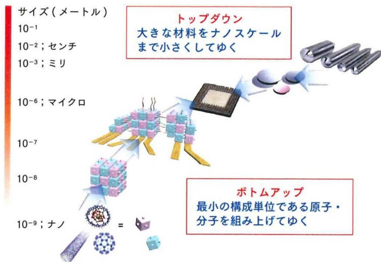
図1 2つの代表的な微細加工技術 トップダウン技術とボトムアップ技術。
