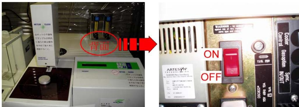
DSC 本体の背面、N<sub>2</sub> ガス流量調節器の下にある DSC 本体の電源を ON にする。
