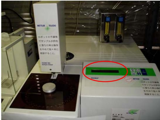
液晶モニターに表示される温度がおおよそ、室温程度で落ち着くことを確認する。
