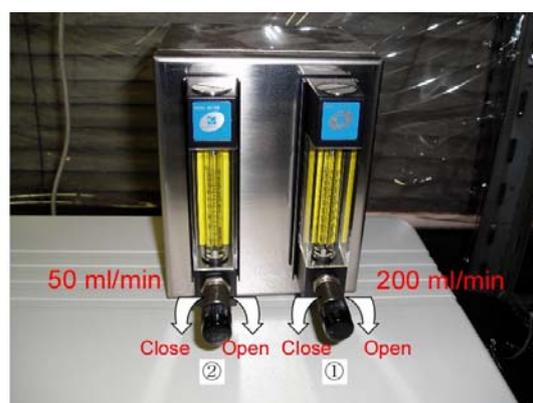
DSC 本体の N<sub>2</sub> ガス流量調節装置のつまみを回して N<sub>2</sub> ガス導入量を調節する。
