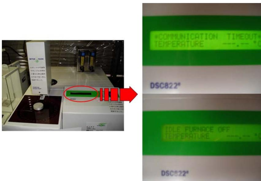
DSC 本体の液晶パネルに Communication time out と Idle furnace off が交互に表示されることを確認する。
