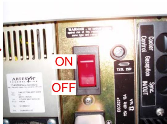
DSC 本体の背面、N2 ガス流量調節器の下にある DSC 本体の電源を OFF にする。
