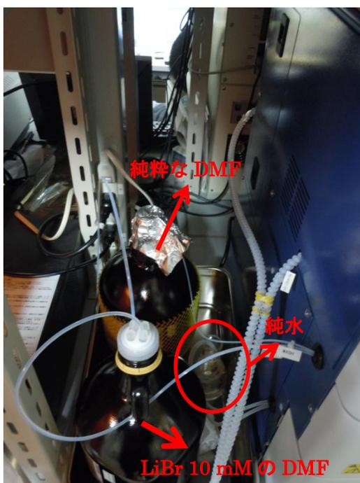
DMF(LiBr 10mM)溶液の作り方・・・DMF 3.0 L(ガロン瓶一個分)に LiBr 1.60g を計りとり攪拌子を入れて攪拌し、よく混ぜ合わせる
