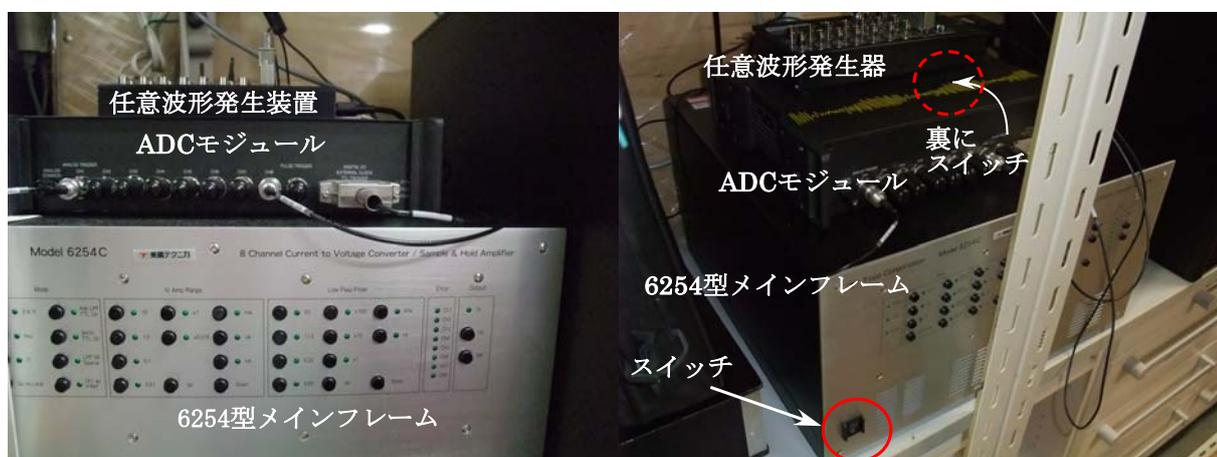
図 1 液晶物性評価装置(6254 型)構成機器
